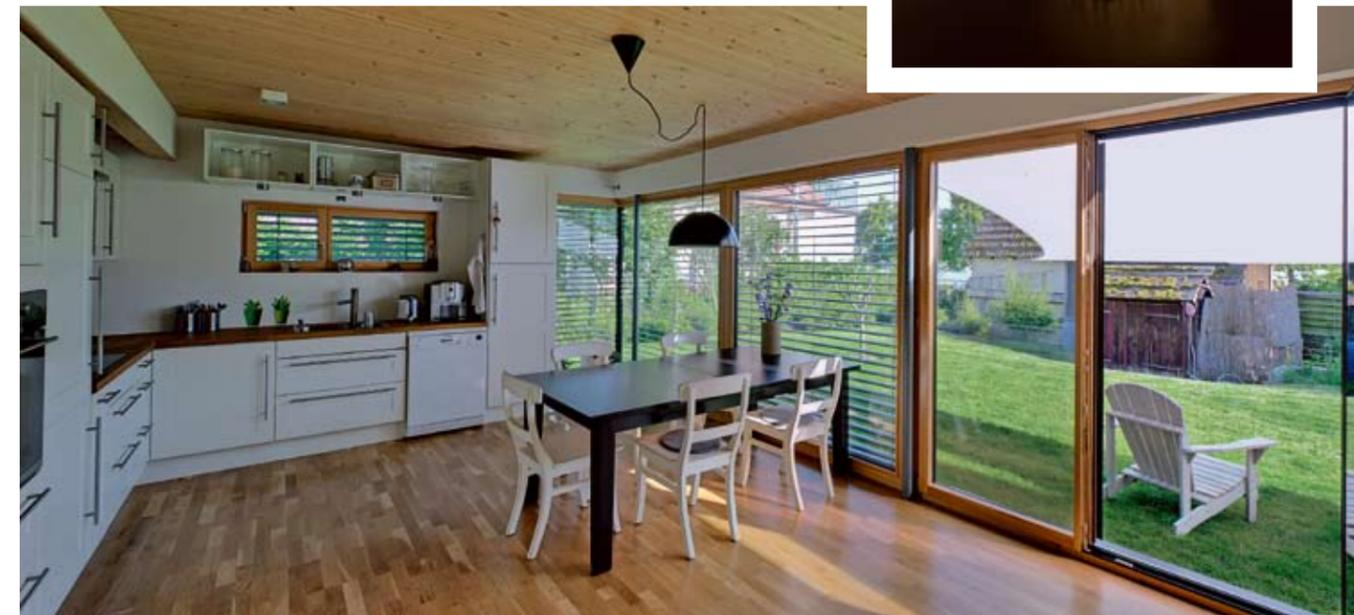
Der offene Koch-, Ess- und Wohnbereich erstreckt sich nahezu über die gesamte Fläche des Erdgeschosses und bietet erholsame Ausblicke ins Grüne. Die Decke besteht aus 16 cm dickem, verleimtem Brettschichtholz, wovon der Holzklötz als Dekoelement zeugt.
